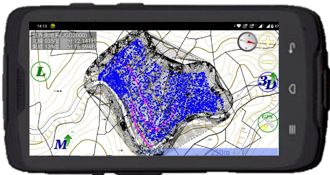
ポータブルGISシステムを実装したGNSSロガー（本機はMobile Mapper 50）
