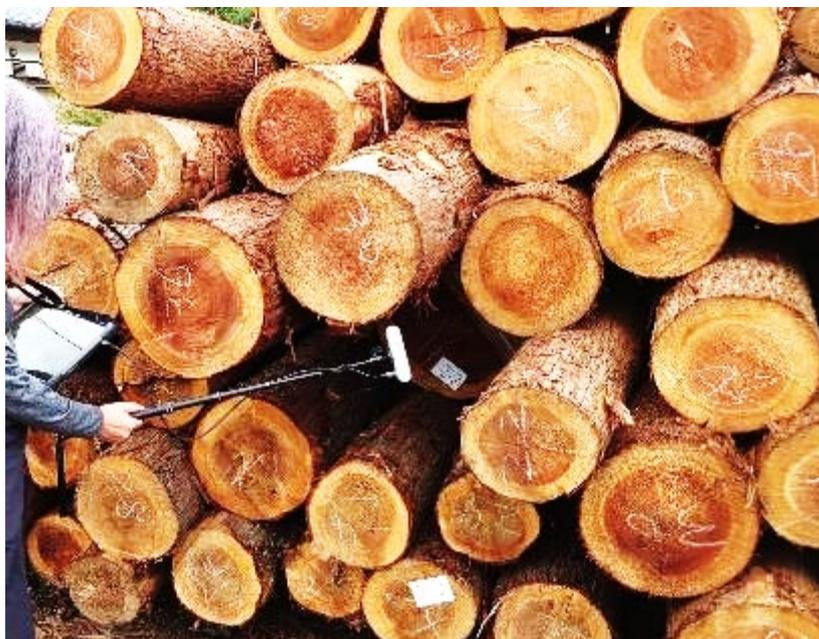
タブレットPCと深度カメラで木口を計測
